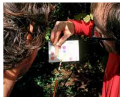
Mesurant l'oxigen dissolt del torrent de la font del Faig a Bagà, voluntaris del Refugi Sant Jordi.
